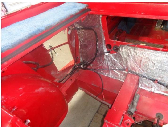
Enrubannage et regainage des faisceaux
