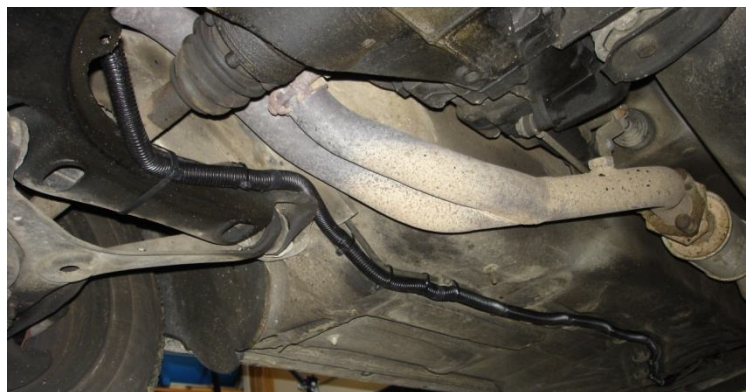
Cheminement câble batterie sous véhicule
