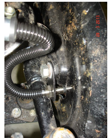
Sonde RallyePack sur roue AV
